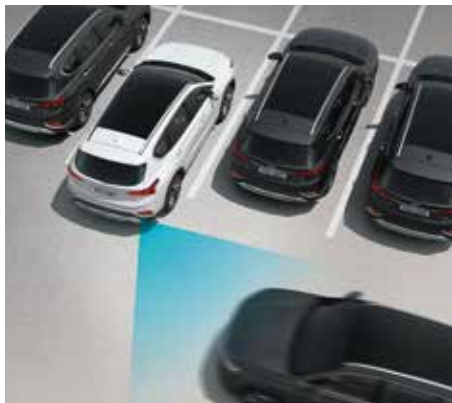
Sistem de avertizare pentru evitarea unei coliziuni la deplasarea în marșarier (RCCW)
