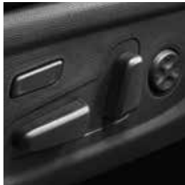
Sistem de ajustare și control scaun conducător auto – 14 moduri
