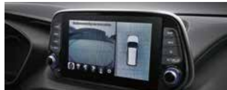
Camere video perimetrale (SVM)
