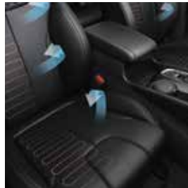
Sistem de ventilație și încălzire scaune față
