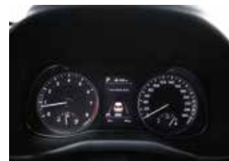
Instrumentar de bord cu ecran color TFT LCD de 4,2"
