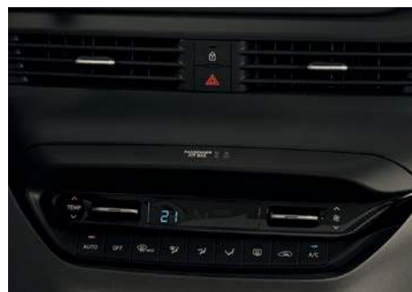
Instalație automată de climatizare.
